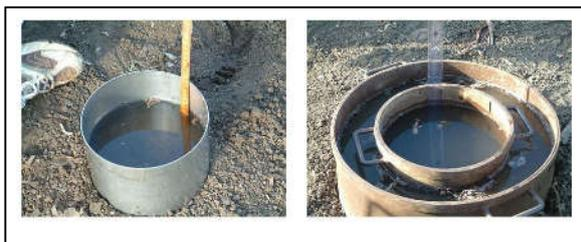
Gambar 2. Alat Pengukur Laju Infiltrasi (*Single Ring Infiltrimeter*)
